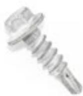
Vite autoperforante a punta ridotta passo legno, con testa esagonale a flangia larga diametro 14 mm, per il fissaggio di elementi su legno o cucitura di lamiere da 0,6 a 2 mm.
